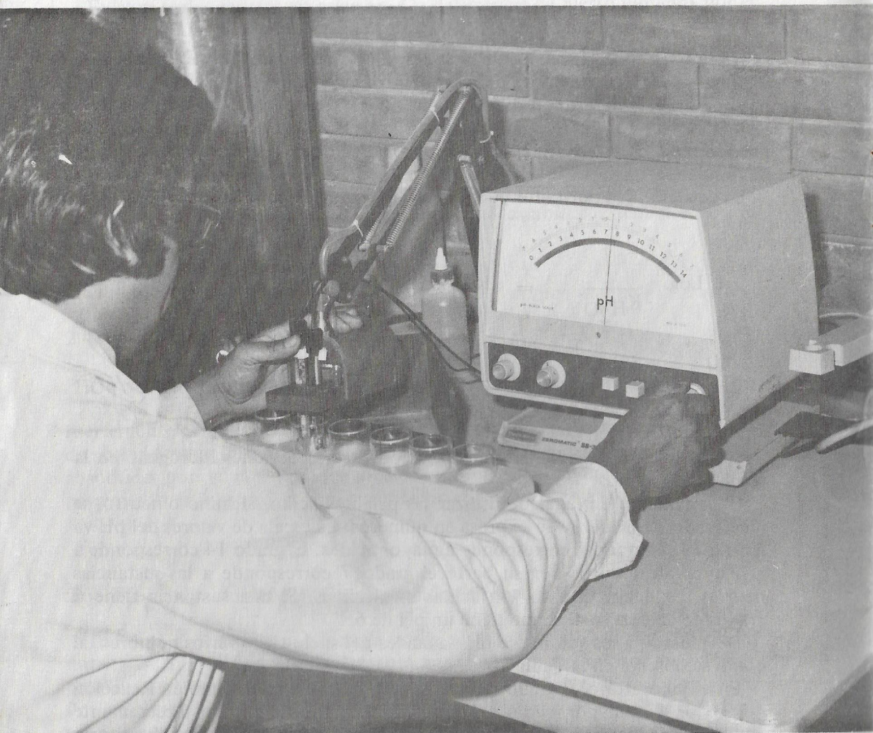
FIGURA 2. Determinación del pH por medio del Potenciómetro.
